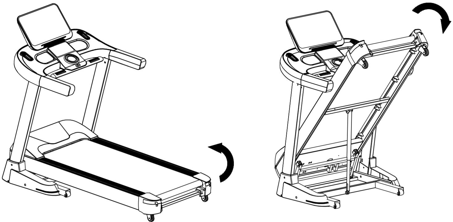
Soulever le tapis vers le haut jusqu'à ce que vous entendiez le "clic" produit par le boîtier de sécurité. le boîtier de sécurité coincé dans le cylindre.
